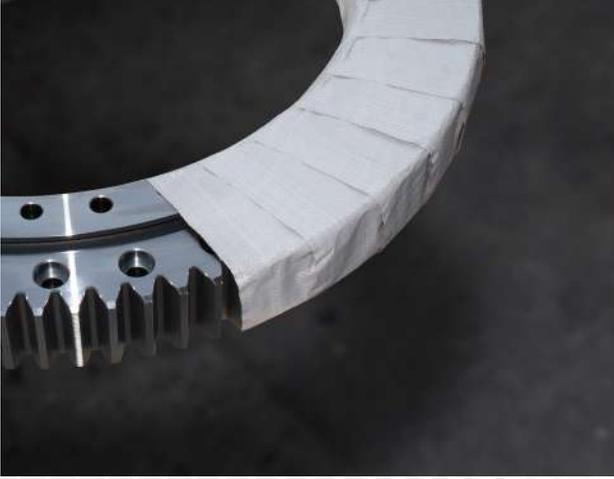
Döner tabla dişlilerinin taşınması ve depolanması esnasında dikkat edilmesi gereken hususlar vardır. Kesinlikle dik olarak taşınmamalı ve depolanmamalı, dik darbelerden kaçınılmalıdır.
